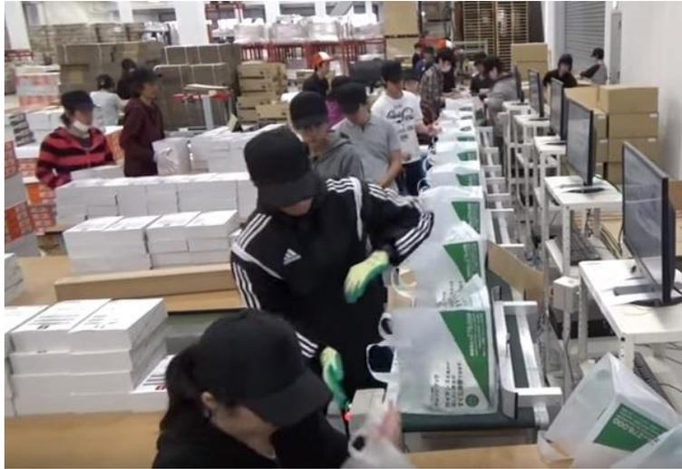
確認画面と目視ボタンの併用により、セットミスを徹底して排除
